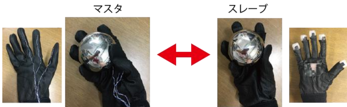
図2 「サーモグローブ」を用いた遠隔地からの温熱感覚の双方向伝送
