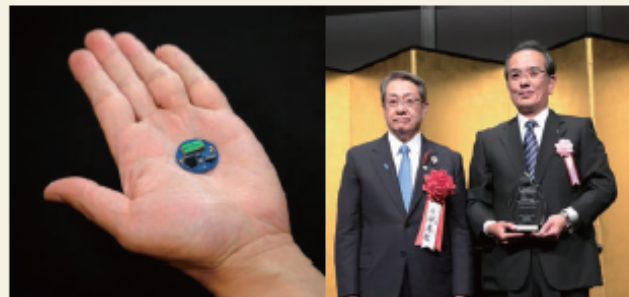
金属上でもアンテナ特性が低下しない 2.4GHz帯の小型・薄型の新アンテナ「Amcenna」 京セラ株式会社
